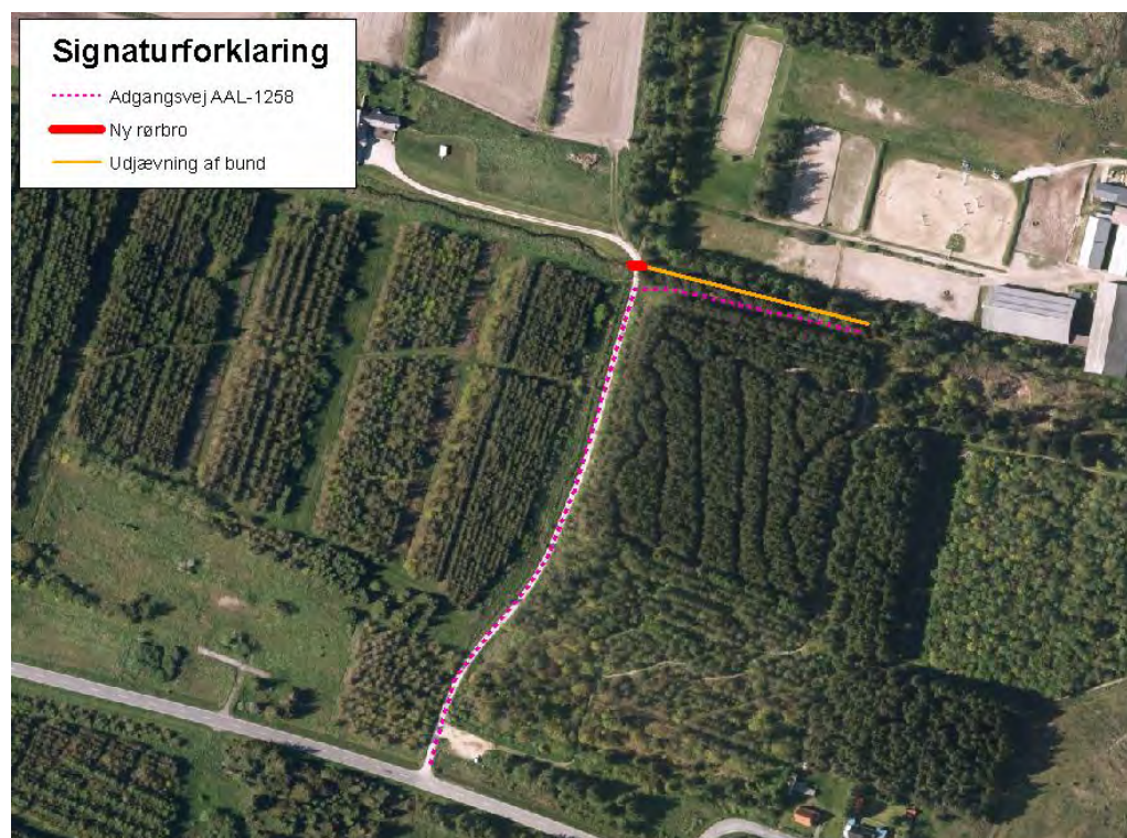
Figur 3-7 Adgangsforhold. Den pink stiplede linjer angiver kørevej til indsats AAL-1258. Den udpegede spærring, som vist i MiljøGIS, er angivet med rødt.
